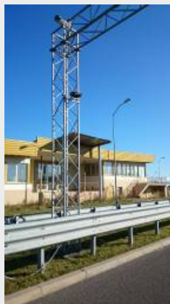
System pomiaru wysokości pojazdu zainstalowany na bramownicy
